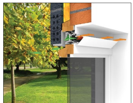
Een zelfregelend ventilatierooster met een opwaartse luchtstroom en een voorverwarmingsstrip voor verbeterd comfort.
